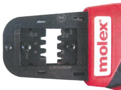
Rysunek 40 - Tabela ustawień zaciskarki MOLEX.
