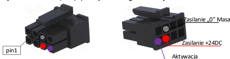
Rysunek 30 Wtyk Molex - zasilanie kasownika
